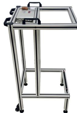
U 型速度测量系统，采用高速传感器，上下 2 组对射安装。通过检测物体穿过 2 组激光传感器的时间差，来计算速度。SPS-U 内置了电压转换模块，支持 DC9V~18V 宽电压供电。启动后即进入 ARM 状态，当物体进入传感位置即触发测量，通过后立即显示速度结果。同时，提供触发输出，分别对应 2 路光电开关作用时刻。另外提供 Remote 功能，可外接大屏幕 LED 显示当前速度；也可通过以太网实现软件控制。
