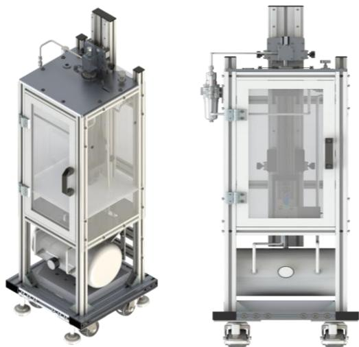
加速度传感器冲击标定系统 SCS-ACS，采用活塞气动冲击原理产生物理加速度，并参考 ISO16063-22 标准进行设计。在软件自动控制下，通过控制冲击压力和气阀开关，获得 25g~2000g 的半正弦加速度峰值。系统采用 Endevco 2270 作为参考标准加速度传感器，其谐振频率均大于 35kHz，并具有极低的温漂 (<3%，-40°C~120°C)，及长期稳定性。系统采用软件自动控制，标定报告自动生成，报告模板可按要求定制。
