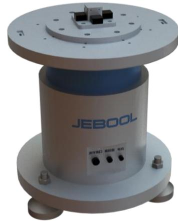
角速度传感器标定系统主要有速率转台和数据采集装置构成, 速率转台按照《GJB 1728A-2019 速率转台通用规范》标准进行设计, 主要由机械台和测控系统两大部分组成。该标定系统具有位置、速率运动功能, 为被测传感器提供定位及速率基准。系统参考《JJF 1535-2015 微机电 (MEMS) 陀螺仪校准规范》实现大量程惯性部件的静态测试和标定, 其台面尺寸  $\Phi 450\text{mm}$ , 总高约 500mm。系统采用软件自动控制, 标定报告自动生成, 报告模板可按要求定制。
